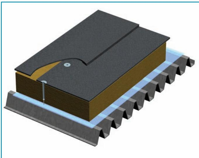
Полимерная мембрана PROTAN - однослойная гидроизоляционная мембрана на основе ластифицированного ПВХ. Стандартный цвет – темно-серый/светло серый.
