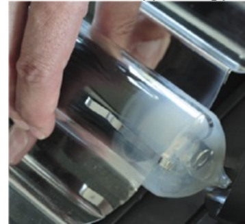
газопоглотитель разрушен, трубка неисправная
