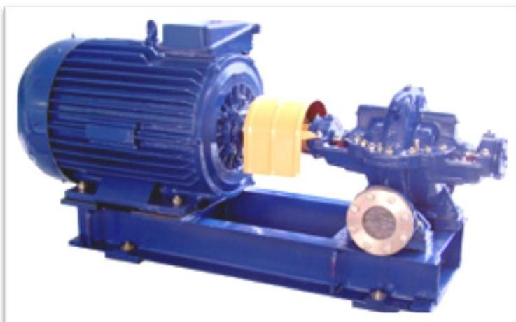
Насосы центробежные двустороннего входа для перекачивания нефтепродуктов и агрегаты электронасосные на их основе, предназначенные для перекачивания незагрязненных механическими примесями нефтепродуктов и воды с примесями нефтепродуктов. Содержание твердых включений в перекачиваемых средах не более 0,2% по массе и размером не более 0,2 мм.
