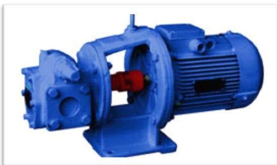
Конструктивно представляют собой объемные насосы. Роль рабочего органа выполняют шестерни. При вращении шестерен на стороне всасывания создается разрежение, и жидкость под перепадом давления (атмосферного и на всасывании насоса) заполняет полости между зубьями, перемещается в сторону нагнетания и вытесняется в нагнетательный патрубок. Условные обозначения:
