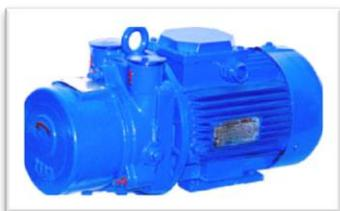
2ВВН1-0,8 предназначены для применения в химической, пищевой, целлюлозно-бумажной, нефтяной, газовой и других отраслях народного хозяйства. Электронасосы относятся к изделиям вида 1 (восстанавливаемые) по ГОСТ 27.003-90. Электронасос 2ВВН1-0,8 имеет моноблочную компоновку и состоит из вакуумного водокольцевого насоса и фланцевого электродвигателя.
