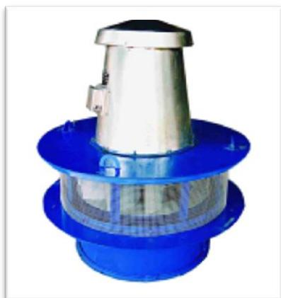
Одностороннего всасывания, Назад загнутые, лопатки ,количество лопаток - 12 шт. Конструктивное исполнение двигателя). Предел огнестойкости 2 ч. При 400°С, 2 ч. При 600°С Сертификат соответствия С-Р1ШБ01.В.00569
