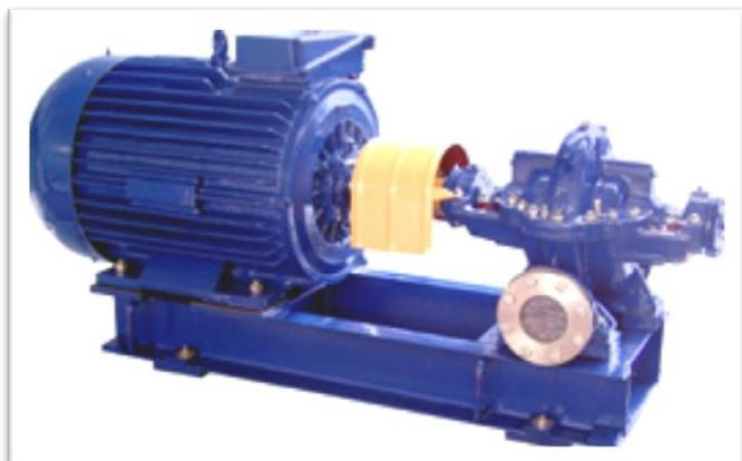
Насосы типа ЦН - двустороннего входа горизонтальные одноступенчатые, с торцовым уплотнением, предназначены для перекачивания нефтепродуктов и воды содержащей примеси нефтепродуктов. Насос допускается для работ во взрывоопасных производствах для перекачивания жидкостей относящихся к категории IIA, IIB и группе взрывоопасности T1, T2, T3 по ГОСТ Р31530,19-99.
