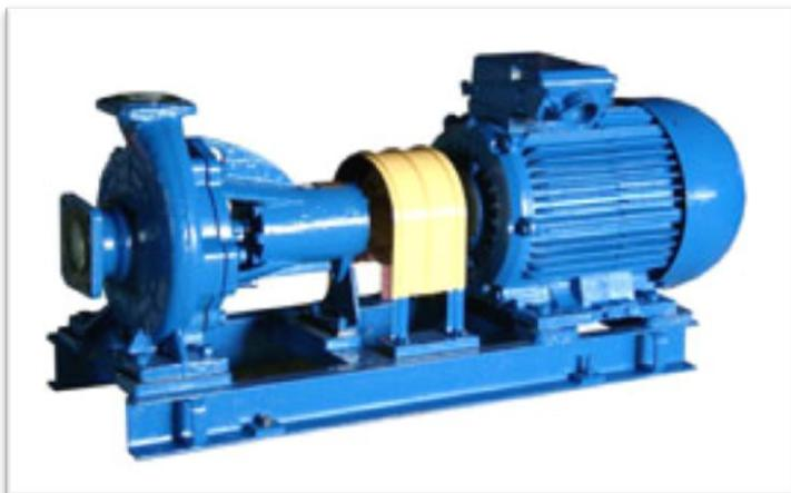
Насосы для сточных масс типа СМ центробежные, горизонтальные, консольные с сальниковым уплотнением вала. Предназначены для перекачивания городских и производственных сточных масс, которые содержат большое количество загрязнений. Проточные каналы насоса выполняются более широкими по сравнению с каналами насосов, перекачивающих чистые жидкости.
