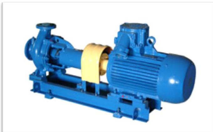
Насос типа 1К - центробежный, горизонтальный, консольный, с сальниковым уплотнением вала. Предназначен для перекачивания воды (кроме морской), жидкостей сходных с водой по плотности, вязкости и химической активности. Материал основных частей - серый чугун. Условные обозначения:
