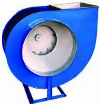
Низкого и среднего давления, Одностороннего всасывания, Корпус спирально-поворотный, Назад загнутые лопатки, Количество лопаток - 12 шт. Направление вращения - правое и левое, Конструктивное исполнение - 1 (колесо на валу двигателя), Предел огнестойкости 2 ч. При 400°С, 2 ч. При 600°С Сертификат соответствия С-гЧ1ШБ01.В.01229
