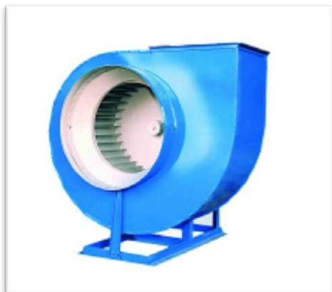
Низкого и среднего давления, одностороннего всасывания, корпус спирально поворотный, вперед загнутые лопатки, количество лопаток - 32 шт. Направление вращения - правое и левое, конструктивное исполнение - 1 (колесо на валу двигателя) Сертификат соответствия РОСС Р11.ГБ04.В01221, Разрешение на применение РС 00-041996
