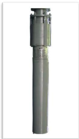
Агрегат электронасосный центробежный скважинный погружной ЭЦВ предназначен для подъёма из скважин воды с общей минерализацией (сухой остаток) не более 1500 мг/л с водородным показателем (рН) 6,5...9,5, с температурой до 298 К (25 °С), массовой долей твёрдых механических примесей - не более 0,01 %, с содержанием хлоридов - не более 350 мг/л, сульфатов - не более 500 мг/л, сероводорода - не более 1,5 мг/л.
