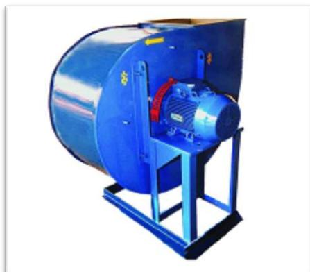
Низкого и среднего давления ,Одностороннего всасывания, Корпус спирально поворотный, Вперед загнутые лопатки, Количество лопаток - 32 шт. Направление вращения - правое и левое, Конструктивное исполнение - 1 (колесо на валу двигателя)
