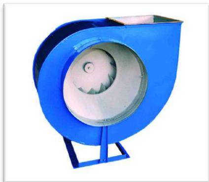
Низкого и среднего давления, одностороннего всасывания, корпус спирально-поворотный, назад загнутые лопатки, количество лопаток - 12 шт. Направление вращения - правое и левое, конструктивное исполнение - 1 (колесо на валу двигателя). Сертификат соответствия РОСС Р11.ГБ04.В01221
