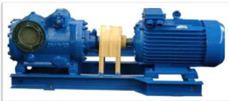
Насосы трехвинтовые типа А1 (А2, А3 и других модификаций) 3В предназначены для перекачивания неагрессивных жидкостей, обладающих смазывающей способностью, без абразивных механических примесей, вязкостью до 1500 сСт и температурой до 100°C (по требованию заказчика до 150°C). Нижний предел вязкости ограничивается смазывающей способностью
