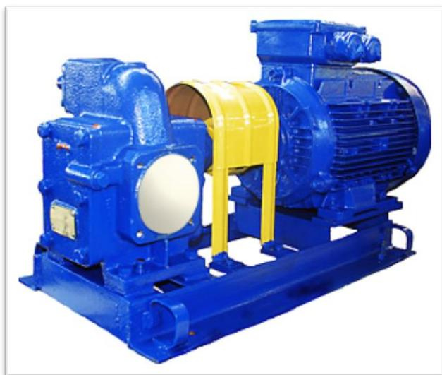
Конструктивно масляные насосы представляют собой объемные насосы. Роль рабочего органа выполняют шестерни. При вращении шестерен на стороне всасывания создается разрежение, и жидкость под перепадом давления (атмосферного и на всасывании насоса) заполняет полости между зубьями, перемещается в сторону нагнетания и вытесняется в нагнетательный патрубок.
