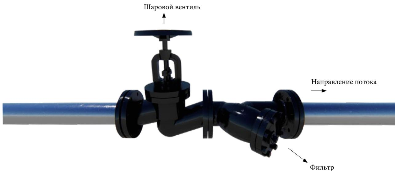
Направление фильтра на паропроводах должно быть горизонтальным, как показано на рисунке. Если он расположен вертикально, из-за конденсации может возникнуть гидравлический удар.
