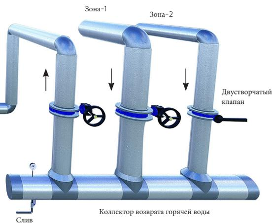
Он помещается в линии горячей воды на выходе из котла перед балансировочным резервуаром
