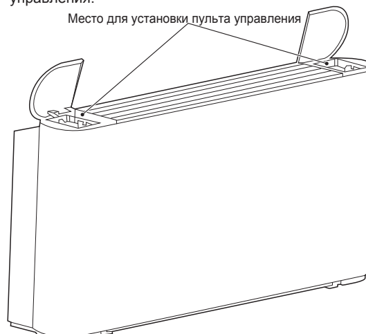
Рис. 3-1 Место для установки проводного пульта управления
