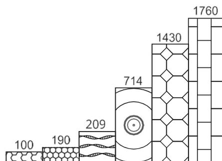
Все строительные материалы при указанной в таблице толщине обладают одинаковым сопротивлением теплоотдаче  $4,76 \text{ м}^2\text{К/Вт}$ .
