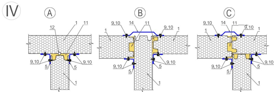
Варианты крепления перегородочных панелей к потолочным
