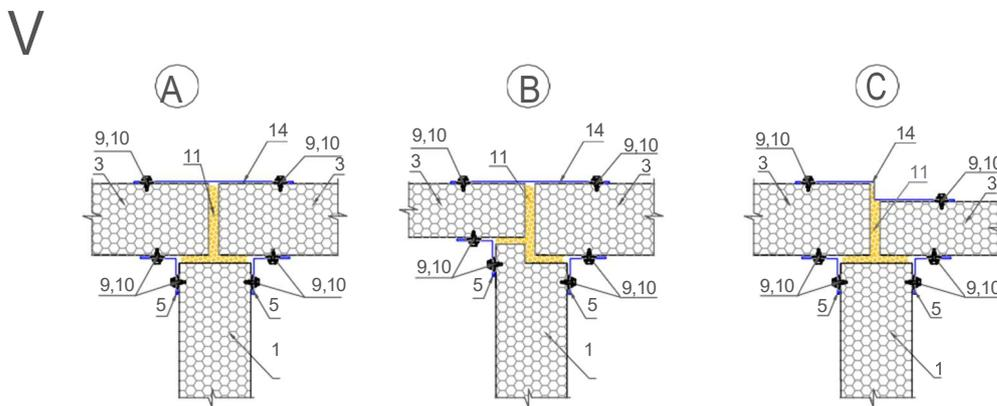
Варианты крепления перегородочных панелей к панелям для пола
