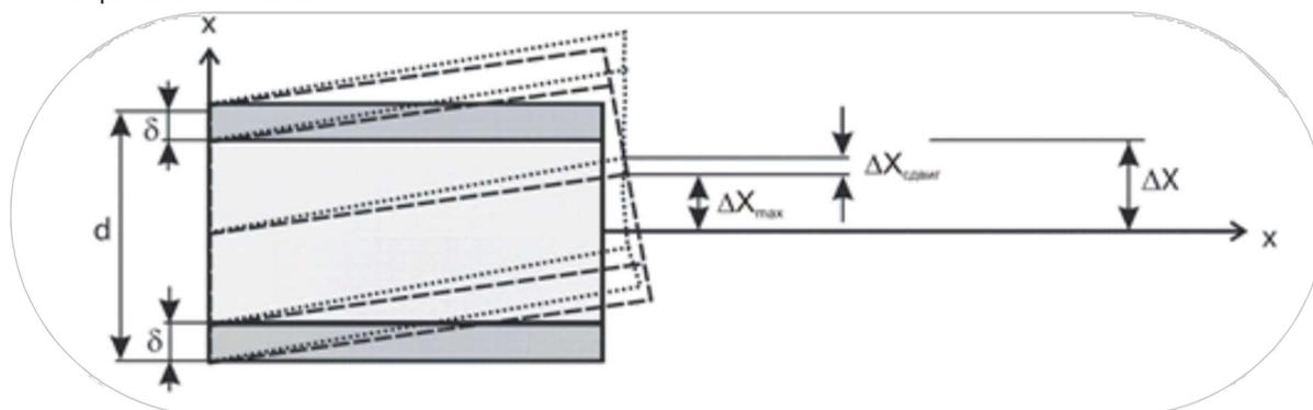
На рисунке 8 показано общее отклонение панели от нормального положения, вызванное изгибом и сдвигом. Первое слагаемое в приведенном выше выражении, хорошо известное из теории балок, описывает изгиб панели, а второе — ее сдвиг, возникающий за счет сдвига сердцевины. Коэффициенты  $k_1$  и  $k_2$ , зависящие от граничных условий, приведены в таблице ниже.
