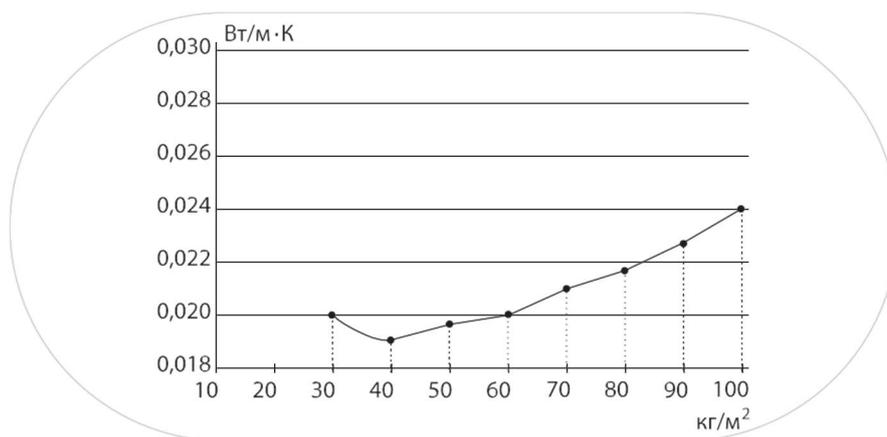
Как видно из графиков, лучшими теплоизоляционными свойствами обладает ППУ плотностью около 40 кг/м<sup>3</sup>. Образцы сэндвич-панелей с наполнителем такой плотности также имеют достаточную конструктивную жесткость.
