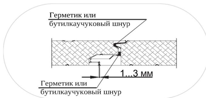
Для низкотемпературных складов и камер мы настоятельно рекомендуем удалять уплотнительную ленту и герметизировать стык монтажной пеной. Для камер и складов со средней плюсовой температурой допускается стыковка панелей без применения монтажной пены. В этом случае уплотнительную ленту удалять не нужно.
