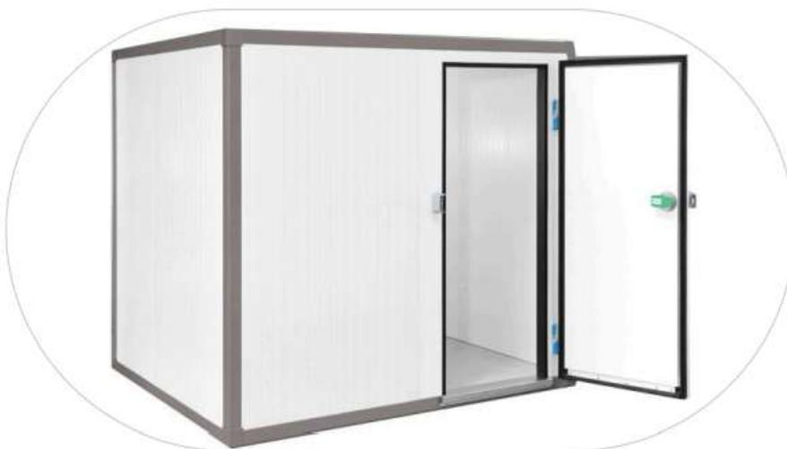
Камера строится из стеновых панелей, панелей для пола и потолочных. Панели дополняются фасонными элементами из металла того же типа и цвета, что и обшивка панелей. Панели для пола необходимо усиливать листами фанеры или «Квинтета», так как сэндвич-панели не предназначены, чтобы выдерживать постоянную пешеходную нагрузку или проезд погрузчиков, тележек.
