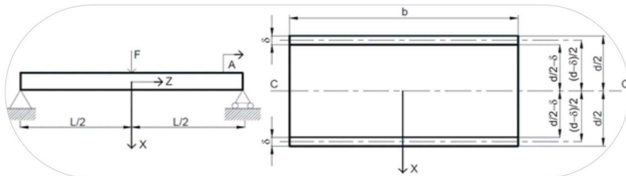
Первое слагаемое в выражении соответствует изгибной жесткости листов металлической обшивки относительно их центральной оси, второе представляет собой изгибную жесткость металлических листов относительно центральной оси панели, третье описывает жесткость полиуретановой сердцевины относительно ее оси, которая, в принципе, совпадает с центральной осью панели.
