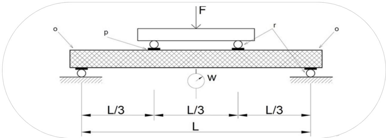
F — приложенная сила, r — валики радиусом 15 мм, w — измеряемый изгиб панели, p — грузораспределительные пластины толщиной 8–12 мм и шириной L<sub>s</sub>, o — выпуск испытываемой панели, не превышающий 50 мм.
