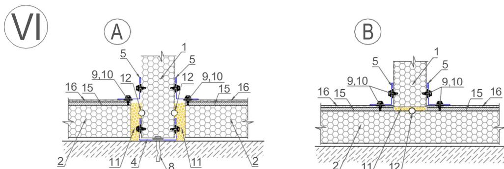
По периметру камеры к заранее выровненному полу с помощью анкеров прибиваются направляющие для стеновых панелей.
