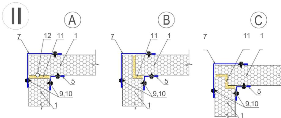
Варианты крепления стеновых и потолочных панелей
