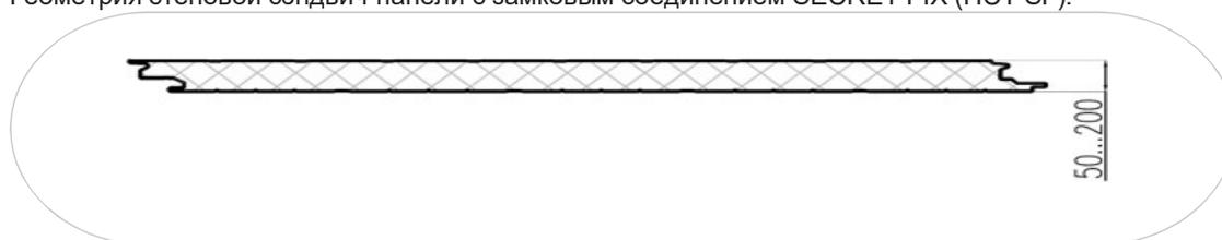
Формы стыковочных замков надежно соединяют металлический лист с полиуретановым сердечником благодаря тому, что в «пазовой» части край металлического листа пронизывает средний слой.
