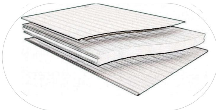
Пенополиуретан состоит из мелких закрытых ячеек. 3% в его объеме занимает твердый материал, 97% — поры, заполненные газом, их плотность обычно варьируется в пределах 24—96 кг/м<sup>3</sup>.
