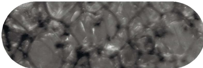
Жесткие ППУ обеспечивают прекрасную теплоизоляцию и достаточно твердые, выдерживают значительные механические нагрузки, поэтому активно применяются в качестве среднего слоя в сэндвич-панелях.
