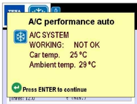
рис 16 – проверка работы A/C не удалась: температура вентилятора слишком высока
