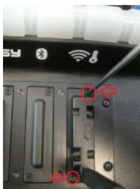
Рис. 7 – фиксация радио модуля на соответствующем разъеме
