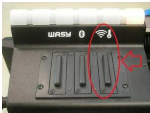
Рис. 3 – расположение радио модуля комплекта проверки эффективности климат-контроля
