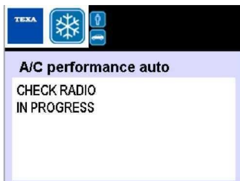
Рис. 12 – проверьте связь между радио модулем и внешним температурным датчиком
