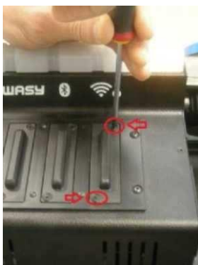
Рис. 4 – снятие винтов с крышки разьема для радио модуля
