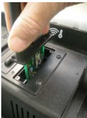
Рис. 6 – установка радио модуля в соответствующий разъем
