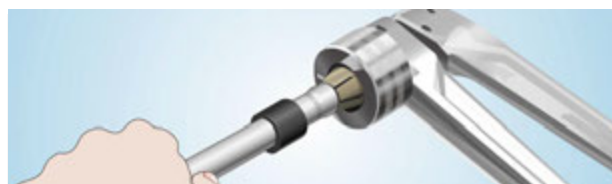
4. Расширьте конец трубы за 3-4 раза, при этом усилие расширения должно быть поступательным, а первое расширение не должно быть более 50%. Расширение за один раз строго запрещено! Это может привести к образованию канавки от ребра расширителя, тем самым может появиться негерметичность соединения
