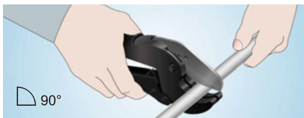
1. Отрежьте трубу под прямым углом
