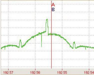
Выявление паразитной модуляции в работе лазера благодаря высокоточному анализатору спектра I-PMD
