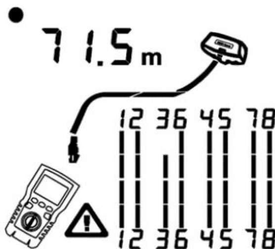
Рис. 6.2 Обрыв на витой паре
