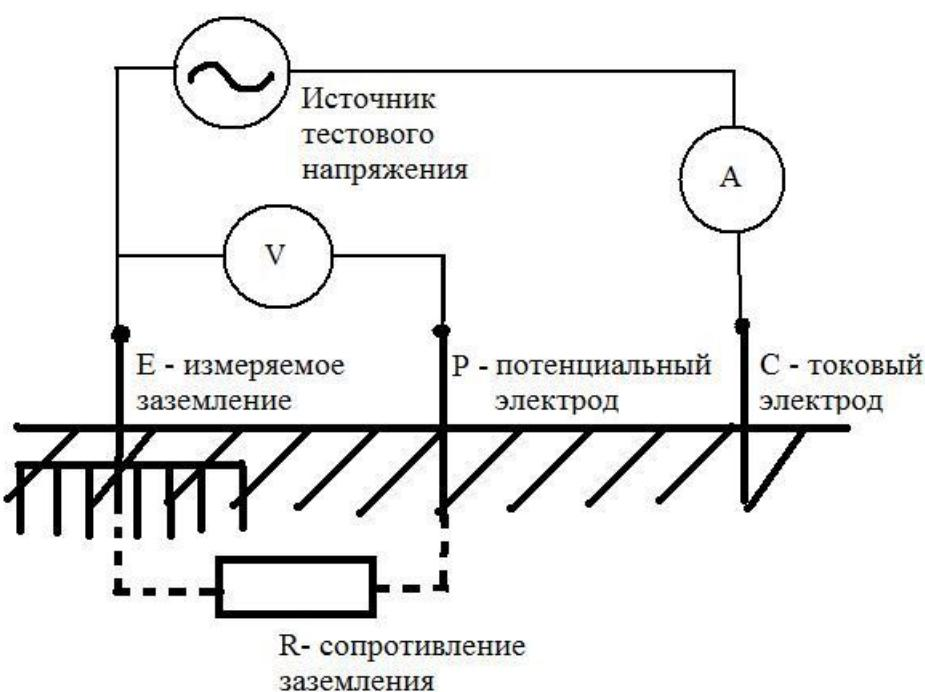
Rи и эталонного Rэ заземления . При пренебрежимо малом сопротивлении эталонного заземления – показания прибора будут приближаться к значению Rи сопротивления измеряемого заземления .
