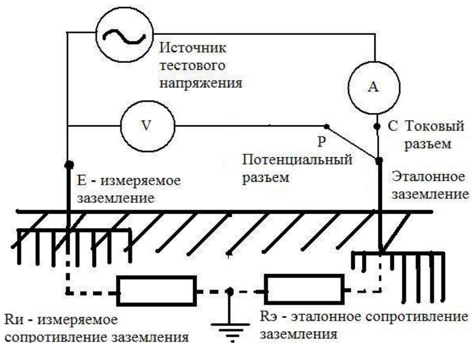
7.2 При 2-х проводной схеме необходимо наличие очень надежного эталонного заземления , сопротивлением которого можно пренебречь . В этом случае потенциальное Р и токовое С гнезда прибора соединяются между собой и прибор генерирует ток , текущий в земле между эталонным и измеряемым сопротивлением . Одновременно с измерением тестового тока A, прибор измеряет напряжение V между электродами . Деля автоматически напряжение на ток – мы получим сумму сопротивления заземления измеряемого
