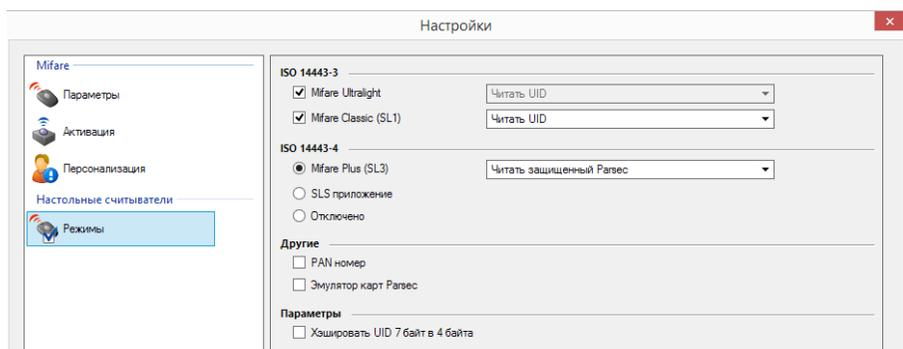
Рисунок 2. Настройки считывателя PR-X18 в ParsecNET 3
