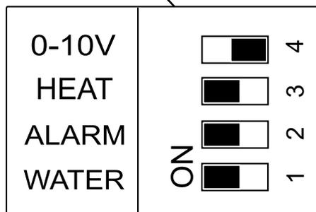
Заводская уставка DIP-переключателей - Модели на горячей воде
