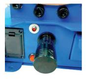
Точная регулировка диаметра опрессовки при помощи лимбуса и индикатора достижения заданного диаметра.
