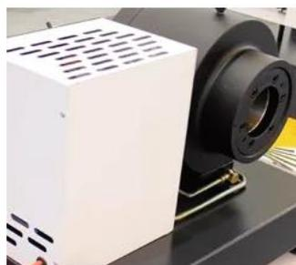
Гидравлическая система без использования РВД: стабильное и равномерное давление на обжимные части.
