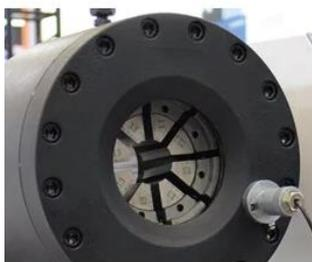
Цилиндр обжимной головы и поршень изготовлен из стали 40X: выдерживает высокие нагрузки без деформаций.
