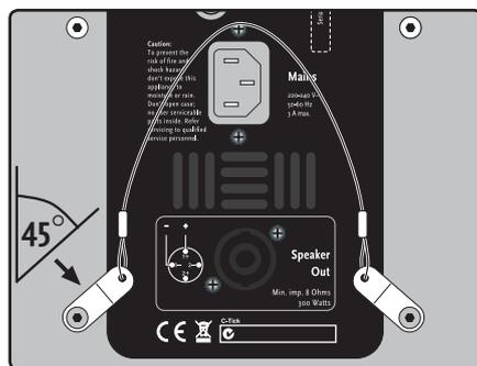
**Montage :** le câble d'orientation vient se fixer sur la face arrière du PR:O 8 A. Il permet une orientation aisée du PR:O 8 A en montage suspendu.
