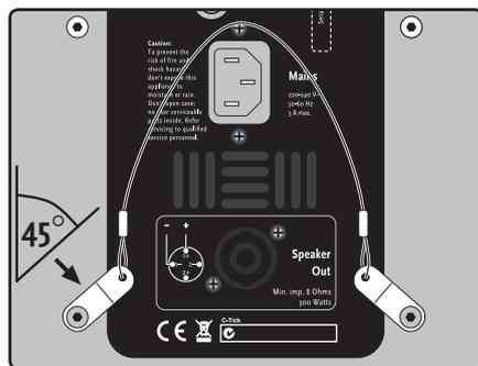
**Montaggio:** il cavo-curving viene fissato sul retro del PR:O 8 A e permette un orientamento esatto del PR:O 8 A quando l'impianto viene montato in sospensione.
