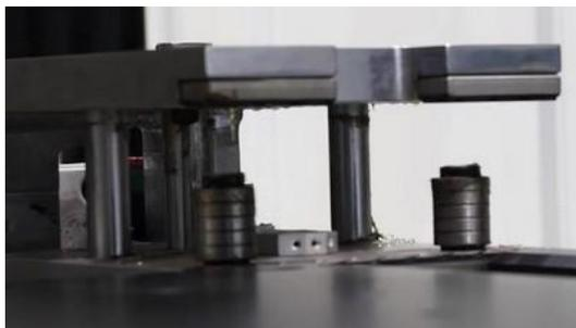
Принудительный автоматический обдув захватов позволяет исключить попадание пыли и стружки, гарантируя чистоту базисуемых поверхностей и идеальную точность сверления. Подшипники качения на упорных штоках захватов исключают повреждение кромки деталей при базировании.
