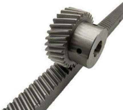
Зубья в косозубых передачах нагружаются постепенно по мере захода их в зону зацепления, в зацеплении всегда находится как минимум две пары зубьев. Данные факторы определяют плавность работы косозубого зацепления, а также снижение шума и дополнительных динамических нагрузок по сравнению с прямозубым зацеплением.
