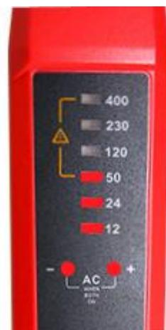
⚠ После определения диапазона обнаруженного напряжения, следует прекратить тестирование. Время тестирования должно составлять не более 5 секунд, чтобы обеспечить более продолжительный срок службы прибора.
