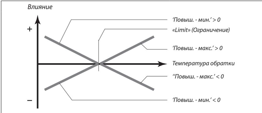
Это ограничение основывается на PI- регулировании, при котором P (коэффициент влияния) быстро реагирует на отклонения, а I (время интегрирования) реагирует медленнее и со временем устраняет небольшую разницу между заданными и фактическими величинами. Это достигается путем изменения заданной температуры подаваемого теплоносителя.
