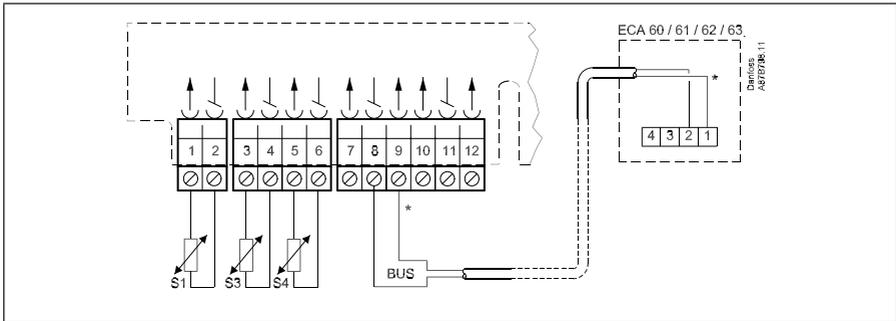
\* Подсоедините клемму 9 ECL к клемме 1, а клемму 8 к 2
