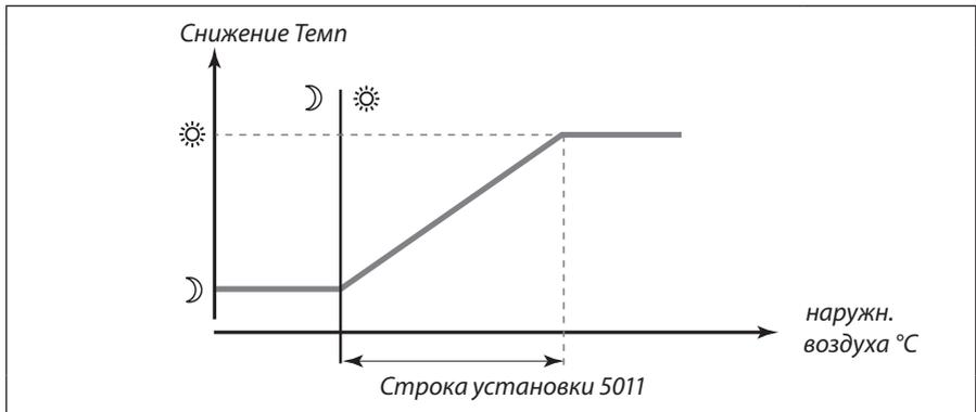
С целью избегания пиковых нагрузок в сети теплоснабжения, можно установить постепенное повышение температуры подаваемого теплоносителя после периода пониженной температуры. В результате этого клапан открывается постепенно.
