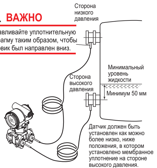
Рисунок 3.7 Установка мембранных уплотнений на резервуаре
