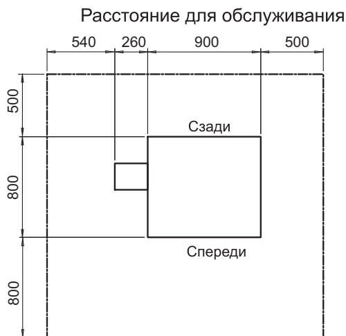
Рисунок 2.4 Габаритные размеры панели (для сталелитейного завода)
