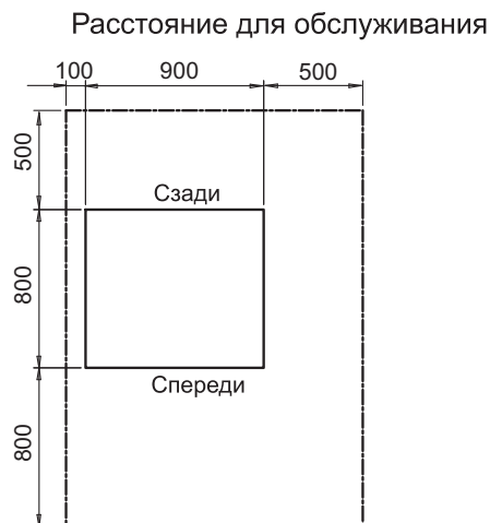
Рисунок 2.2 Габаритные размеры панели (для бытового газа)
