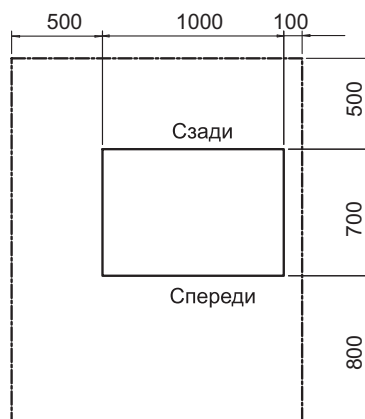
Рисунок 2.3 Габаритные размеры панели (для бытового газа)
