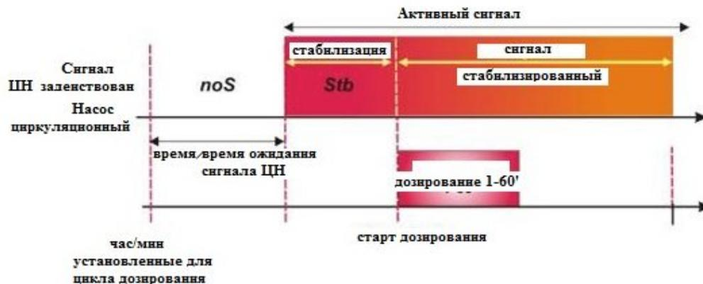
**Fig. 6 Дозирование с сигналом циркуляционного насос (сигнал СН)**
