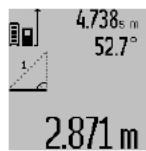
По окончании измерения результат для искомого отрезка «X» отображается в строке результата **c**. Значения измерения для отрезка «1» и угла «**a**» отображаются в строках измеренных значений **a**.
