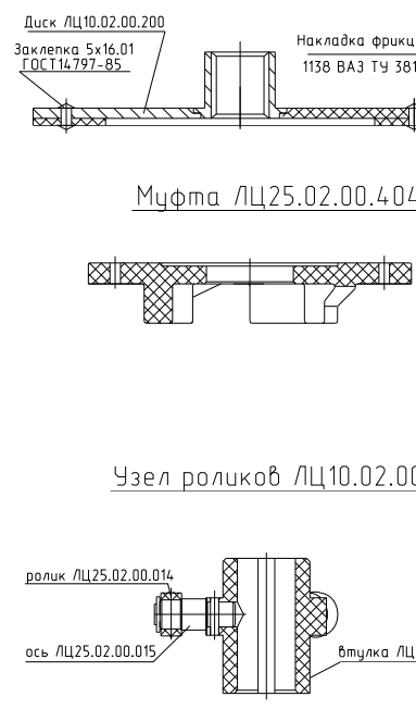
Рис.2а Составные части узла разгонно-тормозного центрифуги ЛЦ10
