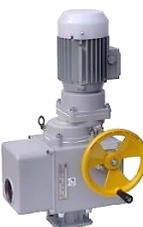
Серия **H-A2**, общепромышленное исполнение; Функция: ОТКРЫТЬ — ЗАКРЫТЬ. С двухсторонней муфтой ограничения крутящего момента и концевыми выключателями. Напряжение питания: 3ф/380В, 50Гц. Подключение: сальниковый ввод (в комплекте); Режим: S2-15 мин., 60 включений/час. Токовый датчик положения 4...20 мА, управляющий сигнал 4...20 мА и контроллер — опция.
