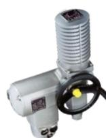
Серия **AUMA NORM**, общепромышленное исполнение; Функция: ОТКРЫТЬ — ЗАКРЫТЬ, напряжение питания: 230В, 380В, 50Гц (двигатель постоянного тока — опция) Подключение: сальниковый ввод (в комплекте). Степень защиты: IP67
