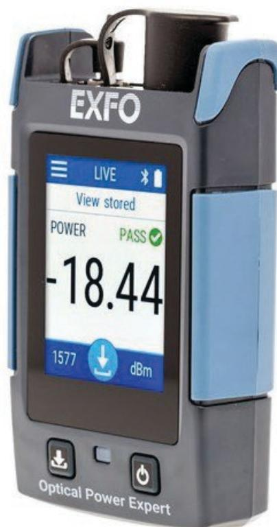
Назначение – измерения мощности сигнала и потерь в оптическом волокне
