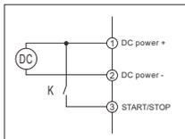
При использовании 24VDC в качестве напряжения питания, присоедините ① к +24V, ② - к 0V. Для управления пуском/остановом электродвигателя используйте соответственно замыкание/размыкание внешнего контакта К. Если кабель до этого контакта слишком длинный, и на входе имеются наводки напряжения, пожалуйста в качестве контакта К используйте внешнее реле, расположенное рядом с УПП. Несоблюдение этого условия может повлечь нестабильную работу, либо даже повреждение УПП.
