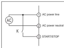
При использовании 100~244VAC в качестве напряжения питания, присоедините ① к фазному проводу, ② - к нейтрали. Для управления пуском/остановом электродвигателя используйте соответственно замыкание/размыкание внешнего контакта К. Если кабель до этого контакта слишком длинный, и на входе имеются наводки напряжения, пожалуйста в качестве контакта К используйте внешнее реле, расположенное рядом с УПП. Несоблюдение этого условия может повлечь нестабильную работу, либо даже повреждение УПП.
