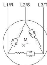
При использовании варианта подключения "внутренняя цепь" УПП последовательно подключается к каждой обмотке двигателя. В этом случае ток силового модуля представляет собой фазный ток, который составляет 1/1,732 от линейного тока.
