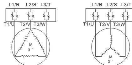
При использовании способа "внешняя цепь" УПП включается между силовой цепью и электродвигателем.
