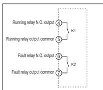
④, ⑤ - клеммы для сигнализации состояния работы УПП. Когда УПП в состоянии разгона, байбаса либо замедления контакт К1 замкнут.
