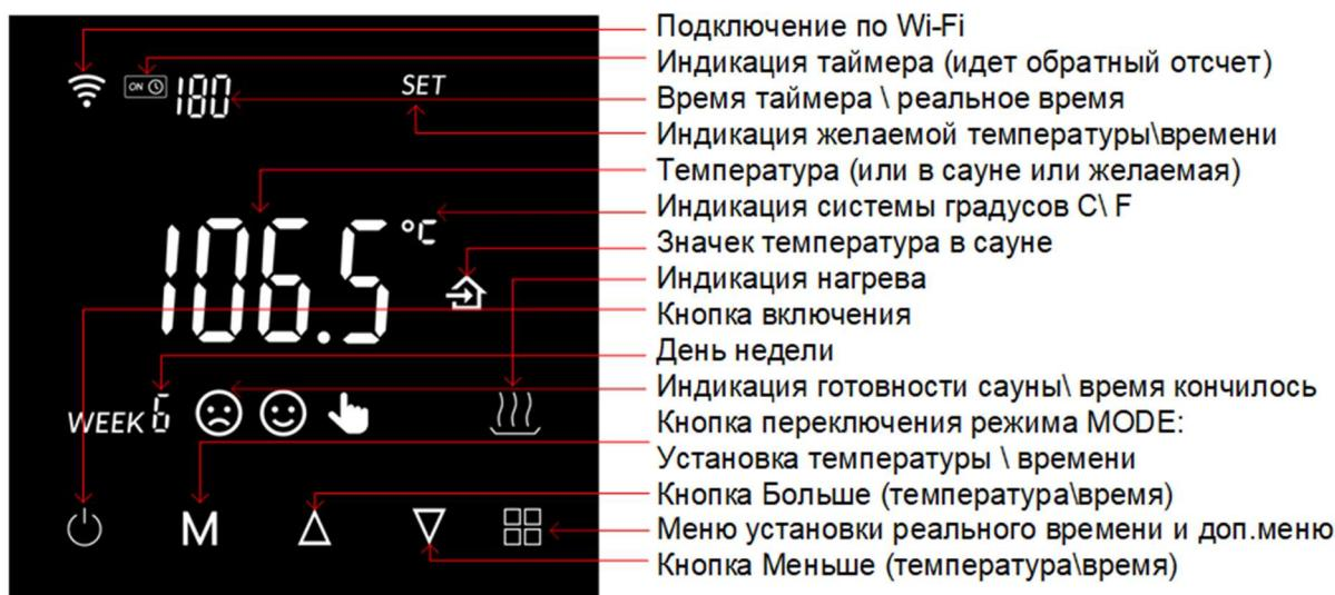
Пульт каменки Henki Smart sauna control model 1 оборудован большим и наглядным дисплеем, отображающим как температуру, таймер, так и текущий статус печи:
