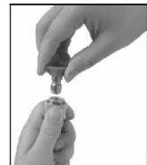
Если форсунка забивается инородными материалами, такими как грязь, чрезмерное давление может увеличиться в системе. Если форсунка становится частично забитой или ограниченной, давление в насосе будет пульсировать. Пожалуйста, немедленно очистите форсунку с помощью полагающегося набора для чистки следуя инструкции:
