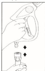
3. Подсоединяя распылительную трубку к пистолету. Надежно затяните, пожалуйста.
