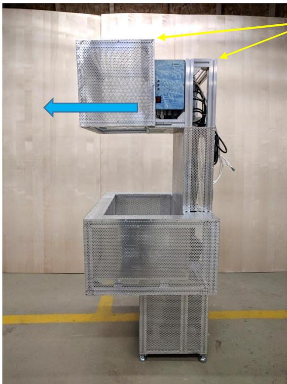
Транспортировочный винт крепления кожуха к поперечному профилю рамы
