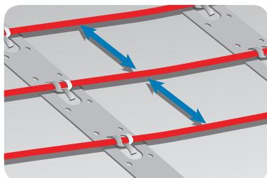
$$\text{Шаг укладки [см]} = \frac{\text{Площадь [м}^2\text{]} \times 100 \text{ см}}{\text{Удельная мощность кабеля [Вт/м]} / \text{Плотность теплового потока [Вт/м}^2\text{]}}$$
