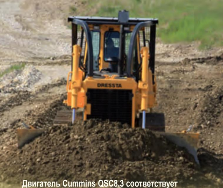
Двигатель Cummins QSC8.3 соответствует требованиям стандартов «EU Stage IIIA» и «EPA Tier 3» по токсичности выпускных газов. Прогрессивная электронная система QSC обеспечивает повышение технических характеристик двигателя, повышает крутящий момент и улучшает приемистость двигателя на любой скорости вращения. Большая периодичность технического обслуживания, отличный запуск машины в условиях холодного климата и низкий уровень шума при работе значительно повышают комфортность работы оператора.
