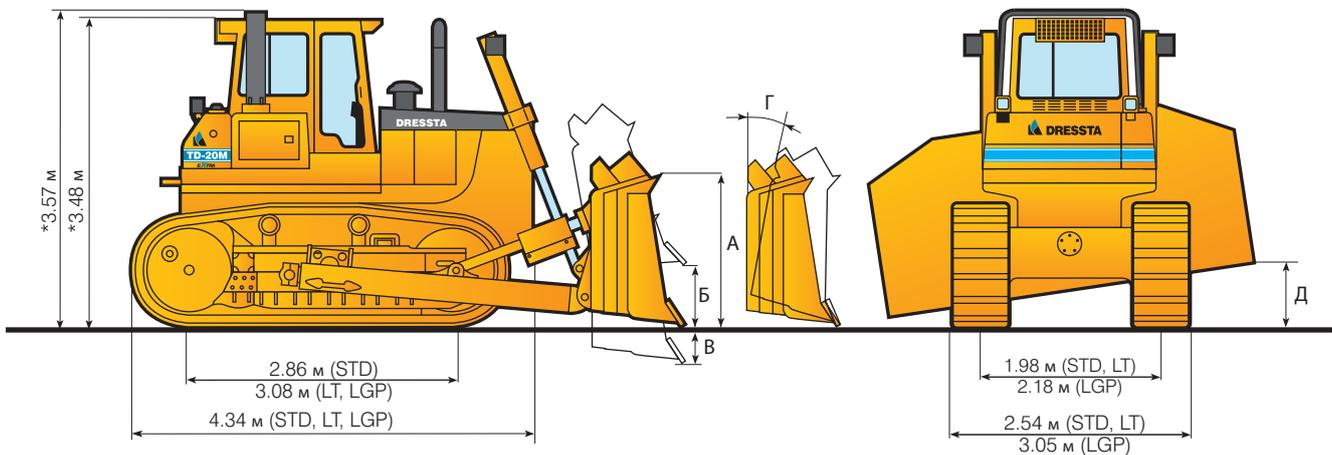
\*РАЗМЕРЫ ВКЛЮЧАЮТ ВЫСОТУ ГРУНТОЗАЦЕПА 67 мм.
