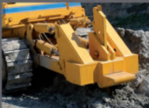
Однозубый и трёхзубый рыхлители оснащаются гидравлическим наклоном
