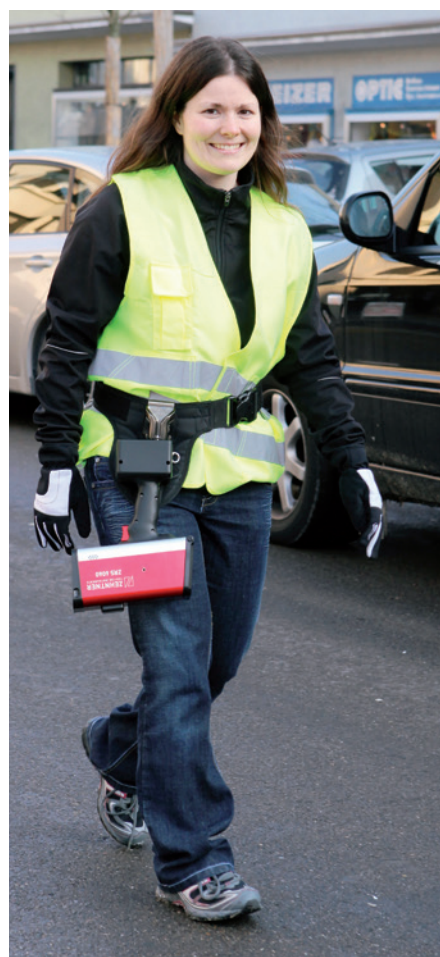
Кобура для эргономичной транспортировки между измерительными участками / Optional holster for ergonomic transport between measuring sites
