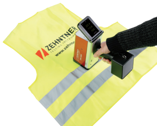
Модель, включающая угол наблюдения 0,2°, подходит для измерения защитной одежды / Versions with observation angle \alpha 0.2° are suitable for measuring safety garments
