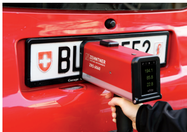
Измерение светоотражающих табличек / Measurement of retroreflective number plates
