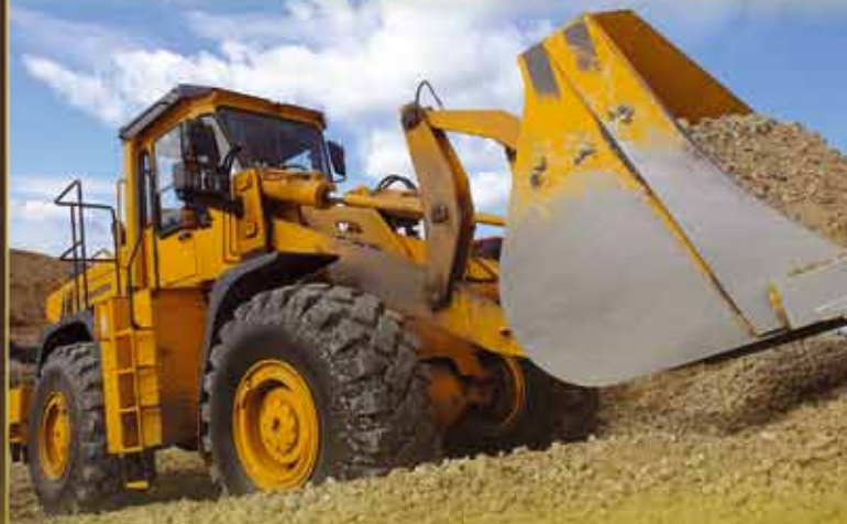
Ковш для сельскохозяйственной продукции (напр. для сахарной свёклы) с выталкивателем при разгрузке
