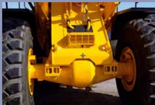
Закрытые, работающие в масле («мокрые»), дисковые, рабочие тормоза, с принудительным масляным охлаждением, обеспечивают работу машины без перегрева при любых рабочих циклах. Герметичная конструкция тормозов защищает их от попадания грязи и увеличивает долговечность, особенно при работе погрузчика в условиях агрессивной рабочей среды, которая встречается на цементных и химических предприятиях.
