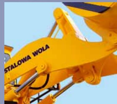
Z-образный, рычажный механизм рамы передаёт максимальное, вырывное усилие погрузчика, что позволяет легко отделять утрамбованную породу. Все соединения погрузчика плотно закрыты, для предотвращения попадания в них абразивной пыли и твёрдых
