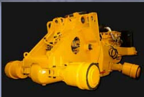
Грузоподъёмность погрузчика увеличена до максимума, благодаря высокому размещению цапф крепления гидроцилиндров подъёма стрелы к передней раме машины, без ущерба для высокой производительности. В задней раме погрузчика установлен узел балансирного крепления заднего моста.
