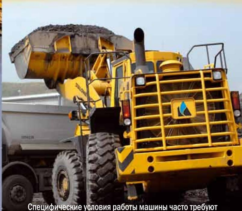
Специфические условия работы машины часто требуют применения ковшей различного типа и специального навесного рабочего оборудования. Для погрузчика 555C Extra в качестве опций, компанией DRESSTA предлагаются: удлинённая стрела (высокой разгрузки), гидравлический челюстной захват, вилы для поддонов и скальных блоков, быстроразъёмное соединение.
