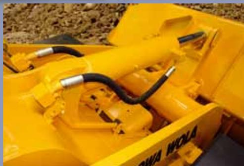
Цельные плечи стрелы погрузчика коробчатого сечения оснащены литыми элементами для обеспечения прочности конструкции, равномерного распределения нагрузок от ковша и дополнительной жёсткости при боковом наполнении ковша.
