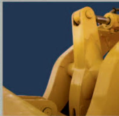
Z-образный, рычажный механизм стрелы обеспечивает максимальное вырывное усилие на ковш погрузчика, что позволяет легко разрывать утрамбованную породу. Все соединения пальцы погрузчика плотно закрыты, для предотвращения попадания в них абразивных частиц.
