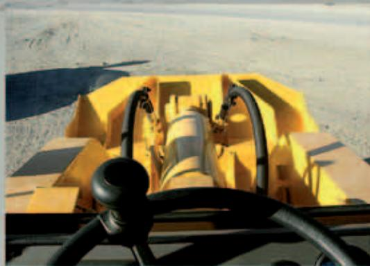
Стрела погрузчика имеет коробчатое сечение, что позволяет ей переносить большие нагрузки при минимальной, для такой конструкции, собственной массе. Снижение массы стрелы, расположенной в передней части машины, улучшает стабильность погрузчика, уменьшает нагрузку на колёсные покрышки, снижает выделение тепла в шинах при загрузке ковша и транспортировке породы. Высокопрочное литьё на концах стрелы плавно распределяет нагрузки и обеспечивает тысячи часов безаварийной работы.
