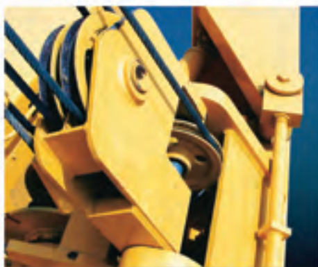
Полиспаст подъема/опускания срылы
