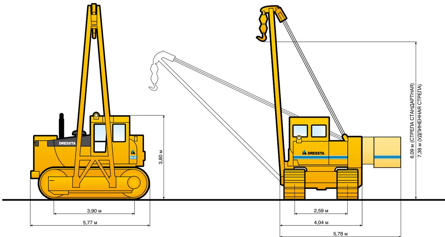
В РАЗМЕРАХ, ОПРЕДЕЛЯЮЩИХ ВЫСОТУ, УЧТЕНЫ 76 мм ВЫСОТЫ ГРУНТОЗАЦЕПА.
