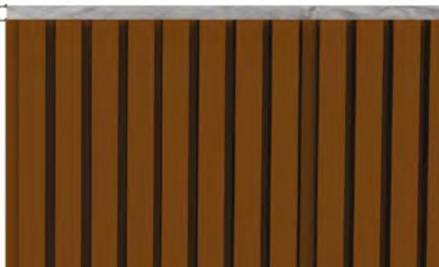
ЗАЗОР СВЕРХУ 3-8 ММ
