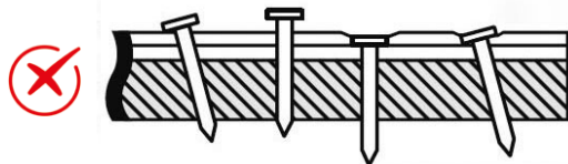
Рис. 3. Пример неправильной забивки гвоздей при монтаже продукции.
