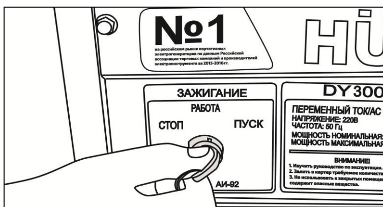
Рис. 17. Запуск двигателя электростартером
