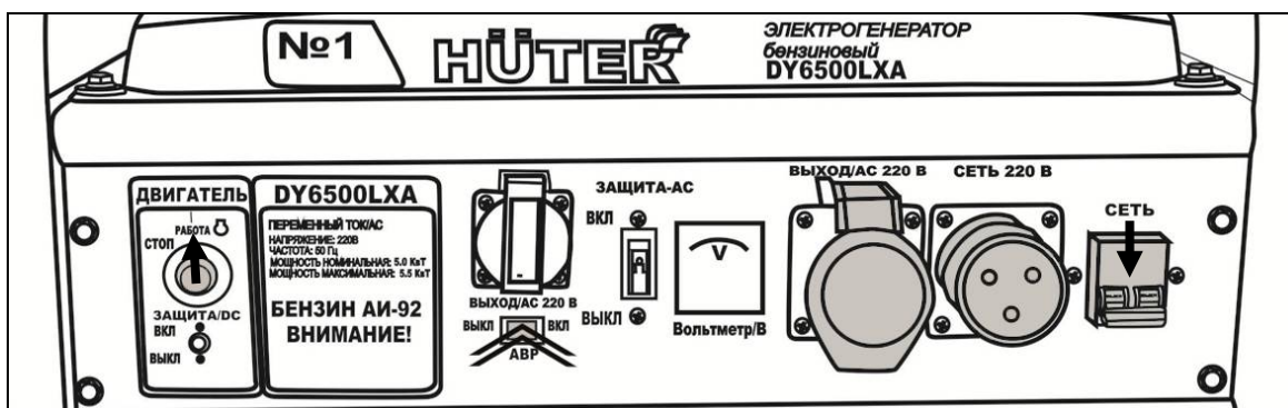
Рис. 21. Панель генератора с встроенным АВР.
