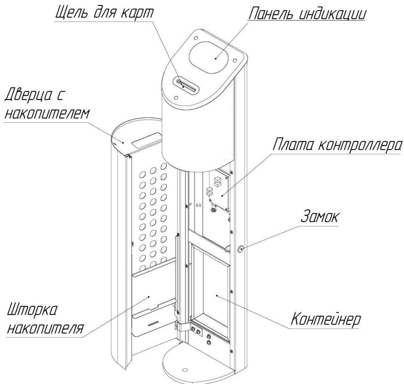
**Рис. 4. Конструкция картоприёмника**
