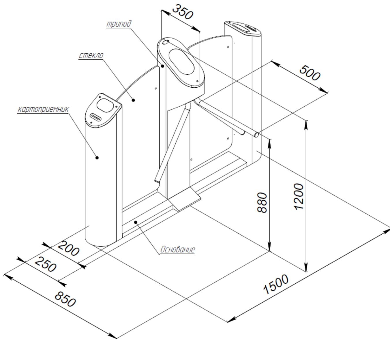
**Рис. 1. Общий вид и габаритные размеры турникета**
