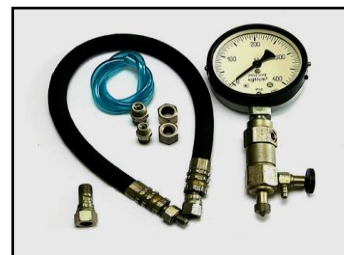
Тестер ТАД-02А -диагностирование форсунок без снятия с дизеля и на стенде по давлению начала впрыскивания и параметрам гидроплотности
