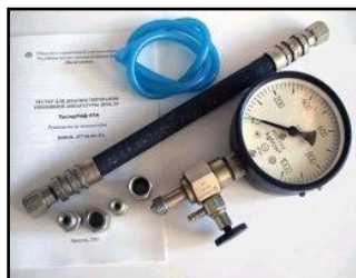
Тестер ТАД- 01А-диагностирование по давлению плунжерных пар и герметичности нагнетательных клапанов: как без снятия насоса с дизеля так и при его стендовых испытаниях
