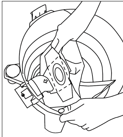
Рис. 7 Установка мешка для сбора пыли
