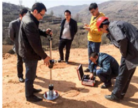
Измерьте несущую способность и плотность грунта, несвязанных слоев грунта быстро, надёжно и точно.
