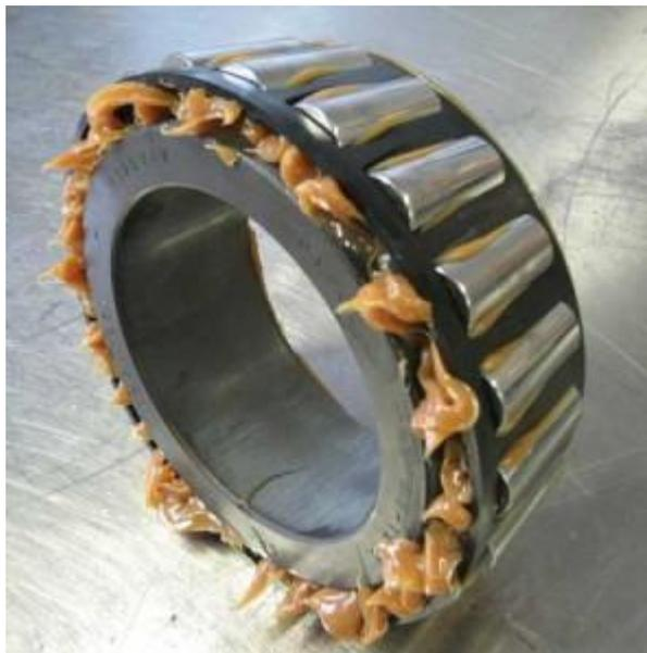
Смазка Солидол (Calcium Grease NLGI 2/3) может использоваться как в летний так и в зимний период, практически во всех индустриальных механизмах, узлах трения транспортных машин, сельскохозяйственной техники, ручного инструмента, в подшипниках качения и скольжения, шарнирах, винтовых и цепных передачах, тихоходных редукторах. Работоспособна при температуре  $(-25)^{\circ}\text{C}$  до  $(+65)^{\circ}\text{C}$
