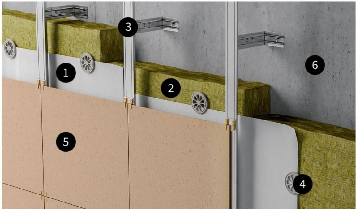
1. Негорючая ветрозащита 2. Утеплитель 3. Навесная фасадная система 4. Тарельчатый дюбель 5. Внешняя отделка 6. Стена здания
