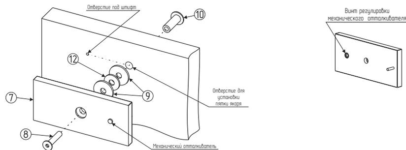
Электромагнитный замок оснащен механическим отпалкивателем. При появлении в процессе эксплуатации остаточной намагниченности, снимите якорь и отрегулируйте отпалкиватель при помощи винта, расположенного с обратной стороны якоря.
